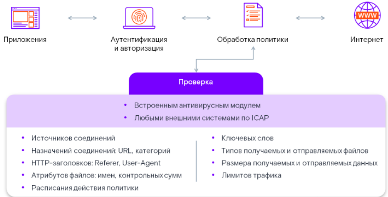
Рисунок 67. Принцип работы Solar webProxy
